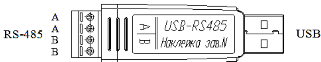
Рис.2.2 Схема подключения «USB-RS485»
