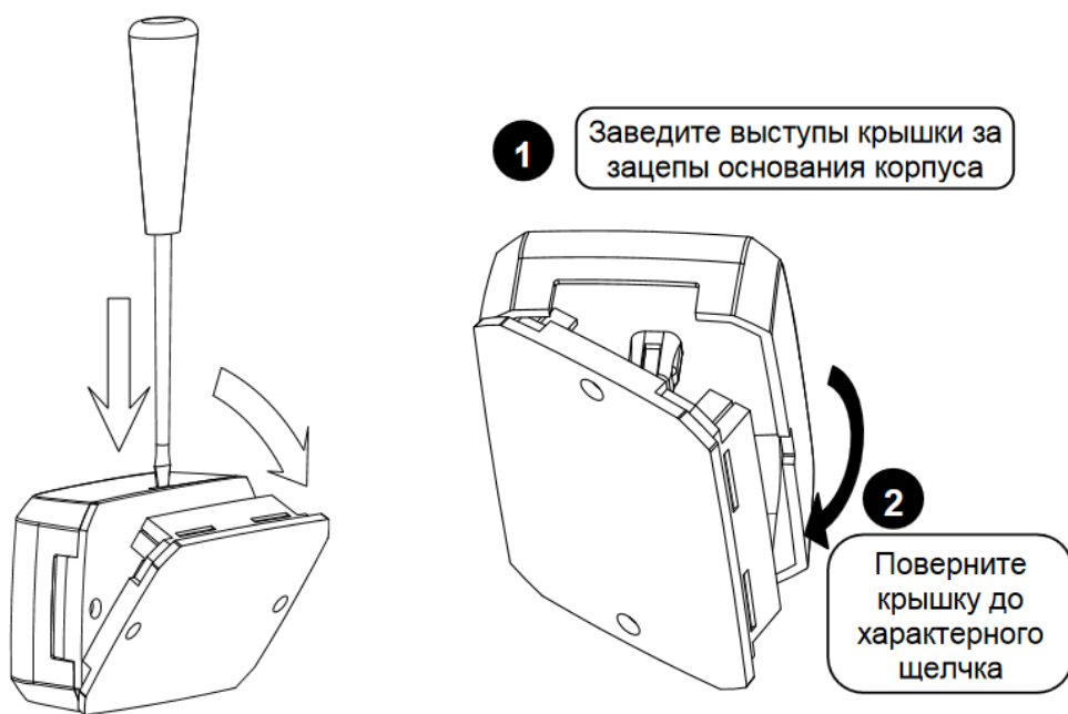
Рисунок 2.3. Снятие и установки крышки преобразователя
