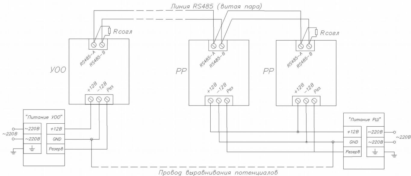
Рисунок 5.1. Схема подключения расширителей к ведущему устройству.
