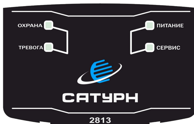
Рисунок 2.6. Панель индикации УОО в исполнении Сатурн-2813
