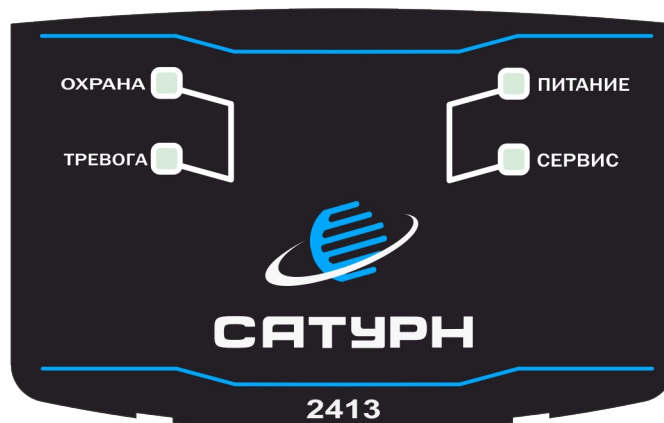
Рисунок 2.5. Панель индикации УОО в исполнении Сатурн-2413
