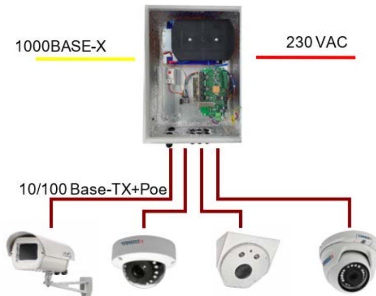
Рисунок 1. Типовая схема подключения коммутатора по оптическому кабелю.
