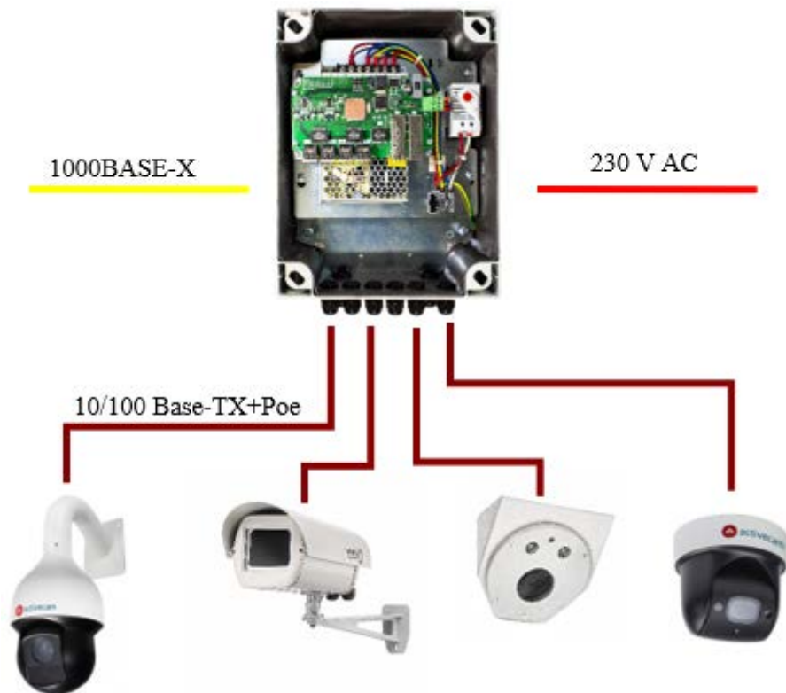
Рисунок 1. Типовая схема подключения коммутаторов по одному оптическому кабелю.
