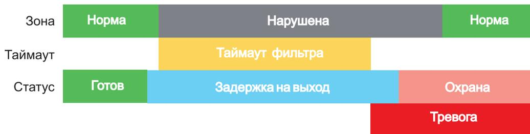
Рисунок 4. Превышен таймаут фильтра для зоны периметр во время задержки на выход.
