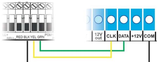
Клеммы специализированного GSM-GPRS передатчика NV 208
