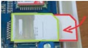
1. Вставьте SIM-карту в слот согласно маркировке на плате. SIM1 в нижний слот.
