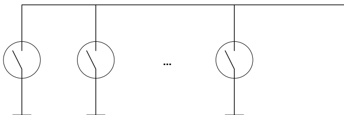
Рис. 5 – Подключение извещателей с нормально разомкнутыми контактами
