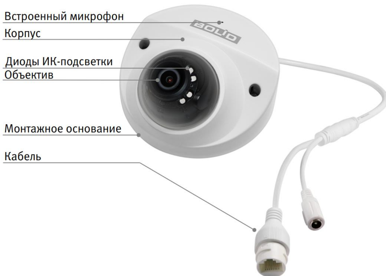
Рисунок 4.1 – Внешний вид и основные элементы видеокамеры
