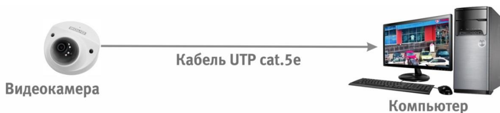
Рисунок 6.2 – Схема подключения видеокамеры к компьютеру
