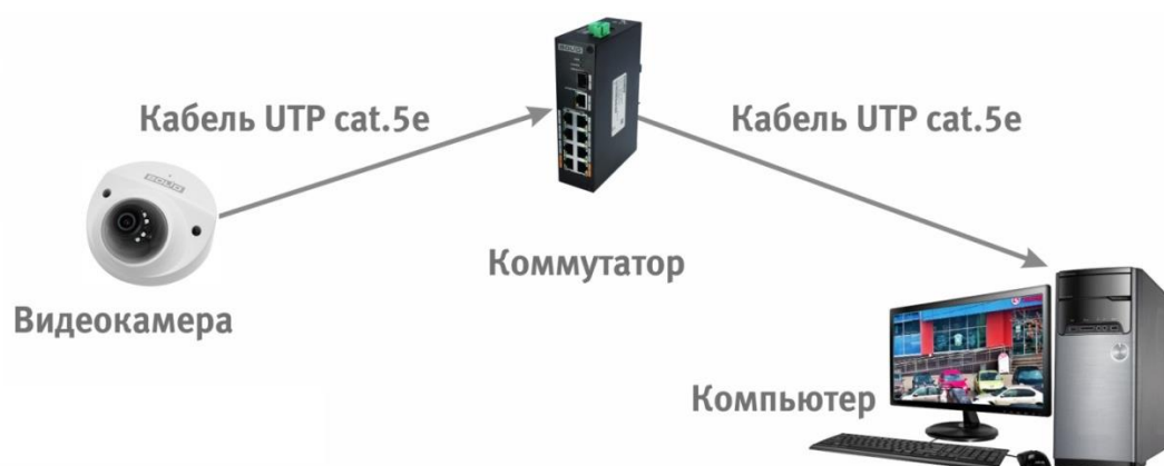
Рисунок 6.3 – Схема подключения видеокамеры к компьютеру через коммутатор
