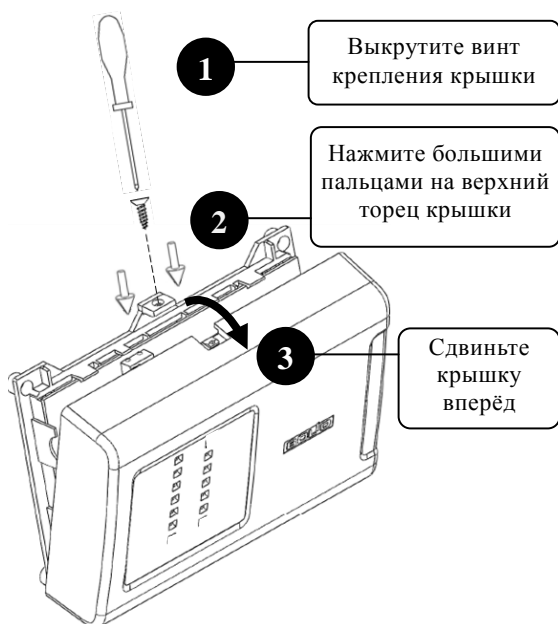
Рисунок 2.2.2. Снятие крышки прибора
