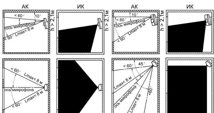
Рис. За Установка ИО «Сатурн-5911» в помещении.
