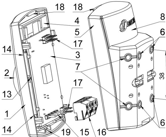
Рис. 1б Конструкция ИО
