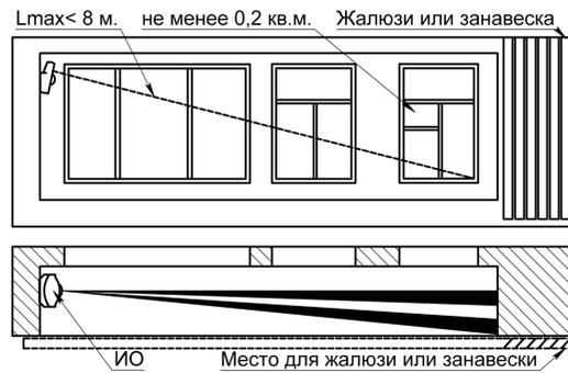
Рис. 36 Установка ИО «Сатурн-5912» в оконном проёме.
