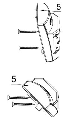
Рис. 6 Крепление ИО к поверхности.
