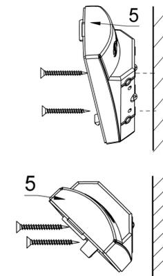
Рис. 6 Крепление ИО к поверхности.
