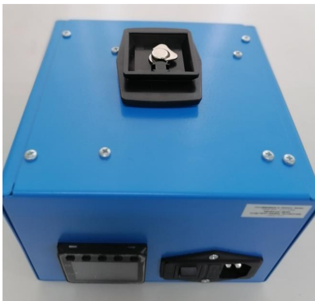
Рисунок 8.6 – Схема установки платформы на АЧТ
