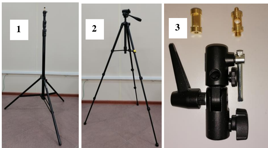
Рисунок 4.4 – Внешний вид стойки (1), штатива (2) и поворотной головки (3)*
