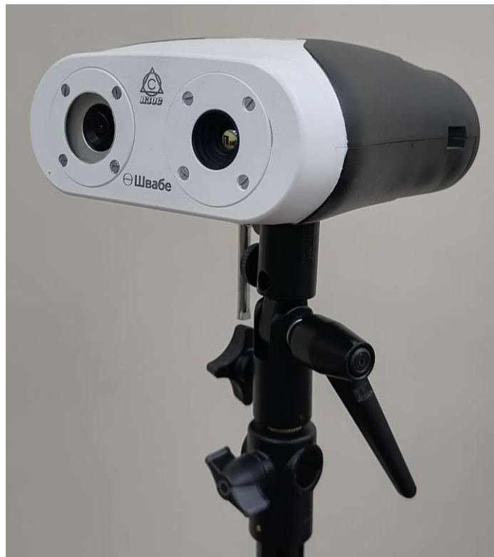
Рисунок 8.5 – Схема установки блока оптического на поворотной головке стойки
